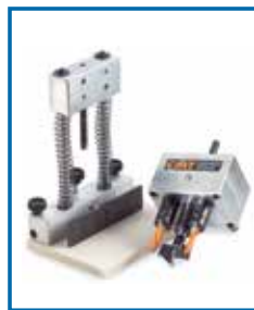
Кондукторы для установки петель
