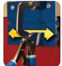
Быстрый съем или сдвиг тисков.
