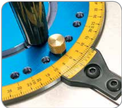
Шкала указателя настраивается с точностью 0.1°.
