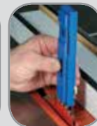
Использование для выставления вылета пильного диска или фрезы
