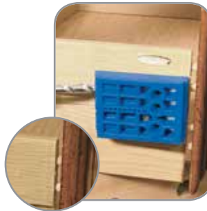
Просверлите отверстия в нужных местах
