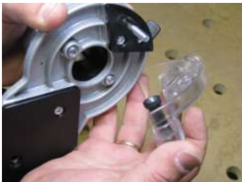
Демонтируйте пылеудаляющий кожух.
