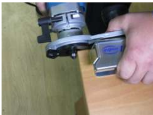
Установите фрезер с насадной на обрабатываемую деталь.
