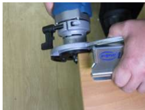
Обработайте угол методом обкатки.
