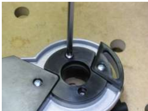
Установите опорный вкладыш и зафиксируйте его.
